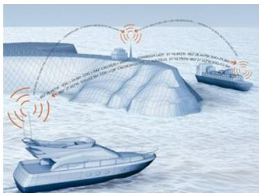
L'AIS (Automatic Identification System) est un système de localisation automatique et d'échange permanent de messages radio VHF entre navires. Ce système est destiné à aider la navigation et permet aux navires et aux systèmes de surveillance de sauvetage (CROSS et MRCC) d'obtenir des
